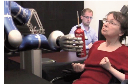
그림 2. 침습적 뇌 신호 측정 및 분석을 통한 로봇 팔의 제어[7]
