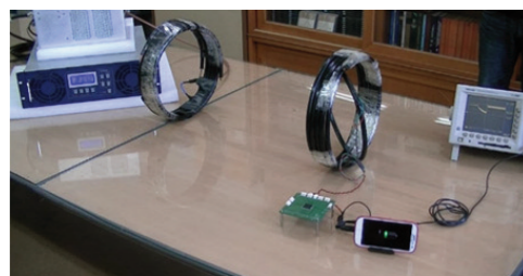
그림 11. 전송거리에 따른 스마트폰 배터리 충전 실험
