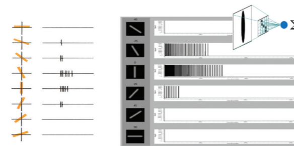
그림 9. CMOS 컨덕턴스 뉴런을 이용한 Hubel과 Wiesel의 Visual Cortex simple cell의 뉴로모픽 뉴런 뉴로모픽
